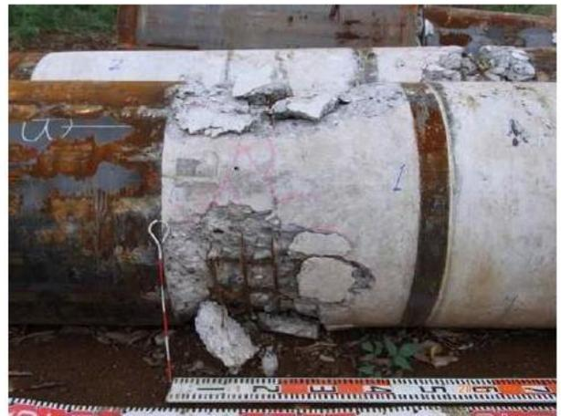
曲げ試験(試験後状況)
