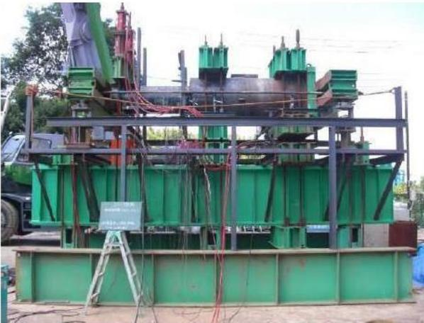
曲げ試験(載荷装置全景)
