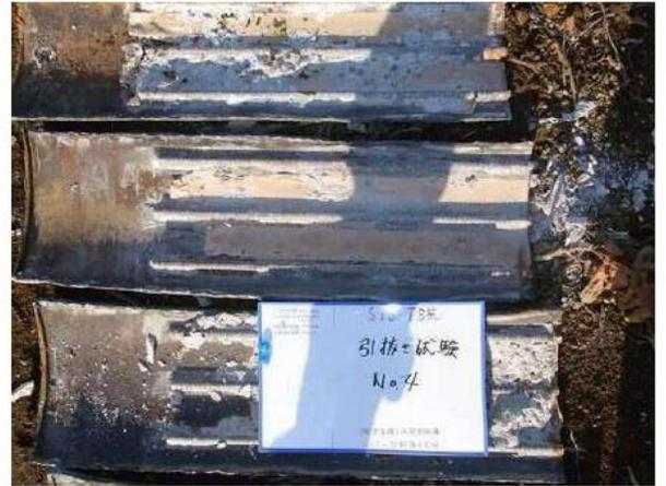
引張り試験(試験後状況)
